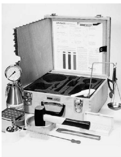
CM-Gerät zur schnellen Bestimmung des Wassergehalts von Betonproben.
