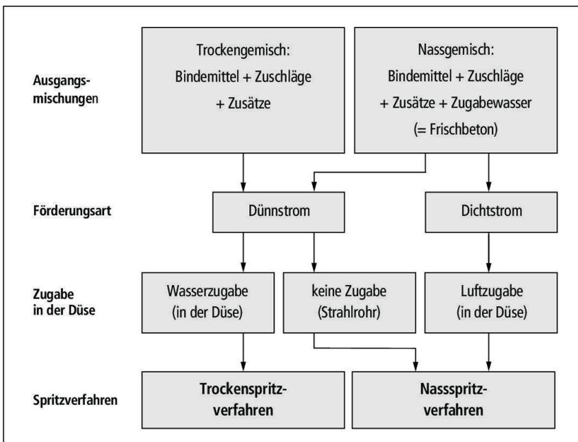
Abb. 2 Verfahrenstechniken beim Spritzbeton (nach [5], leicht modifiziert).
