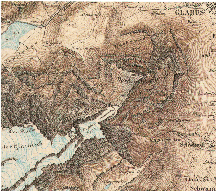
Abb. 4: Ein Beispiel aus der Heimatkunde des Wettstein-Atlas, der Glärnisch in einer Kombination aus Höhenkurven, Schattenschraffen und Felszeichnung. Chromolithographie durch die Topographische Anstalt von Wurster, Randegger & Cie., Massstab 1: 50 000, Abbildung in Originalgrösse (Wettstein, H[einrich]: Schul-Atlas . 3. Auflage. Zürich: Erziehungsdirektion, 1886. Blatt VII [VIII]).
