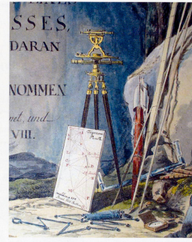
Abb. 6: Ausrüstung für eine Kartierung des Birslaufs 1798: Theodolit, Messkette, Messlatte, Bussolle usw. (Staatsarchiv Basel-Stadt, Planarchiv T, 148).
