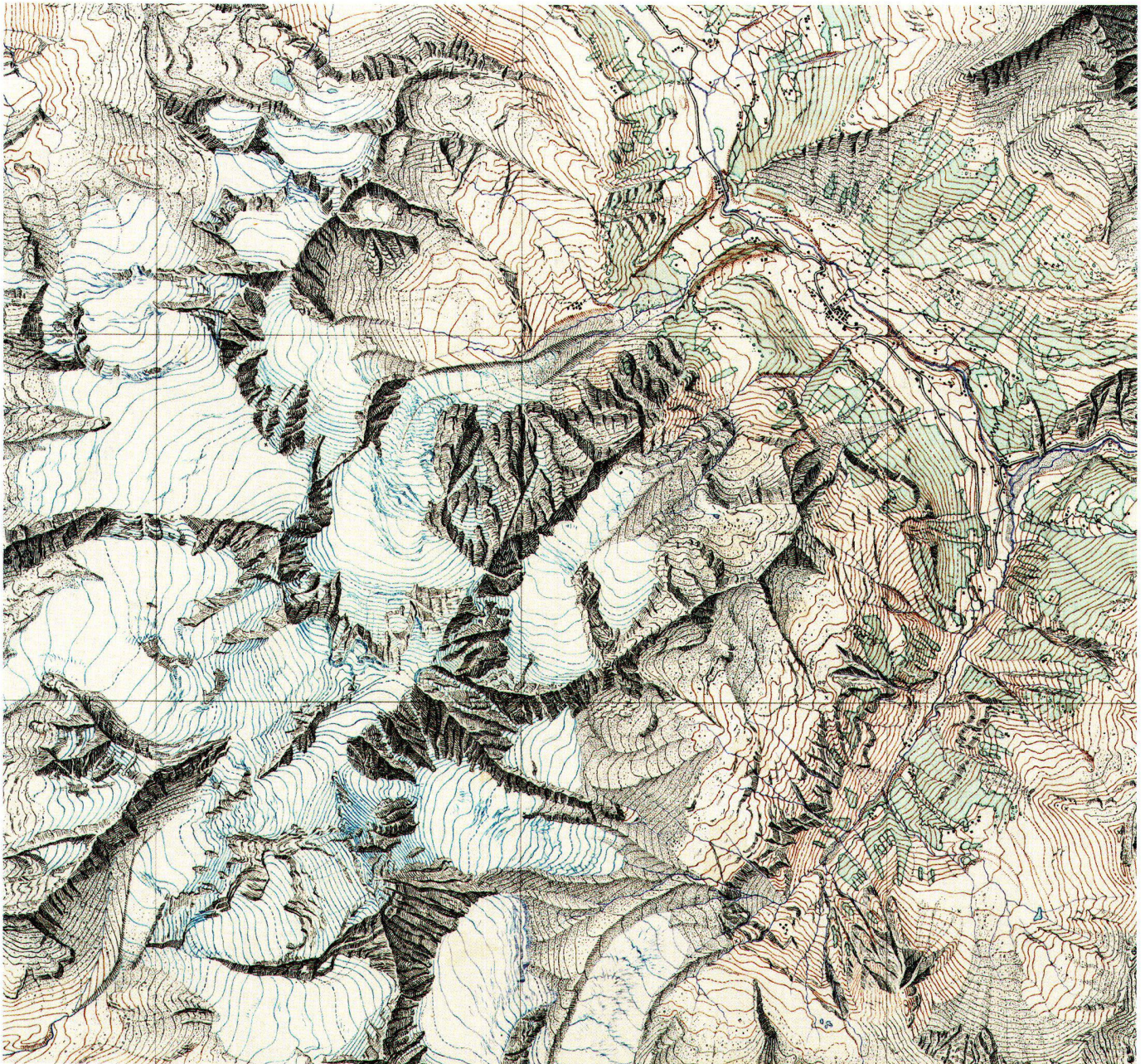
Abb. 3: Messtischaufnahme Sektion XVIII, 14 1:50 000 für die Siegfriedkarte Blatt 501 Simplon von Xaver Imfeld. Neuaufnahme 1886/87. Der Kartenausschnitt im Originalmassstab zeigt das Fletschhorn und den südlichen Teil des Simplonpasses (Kartenarchiv swisstopo, Wabern).
