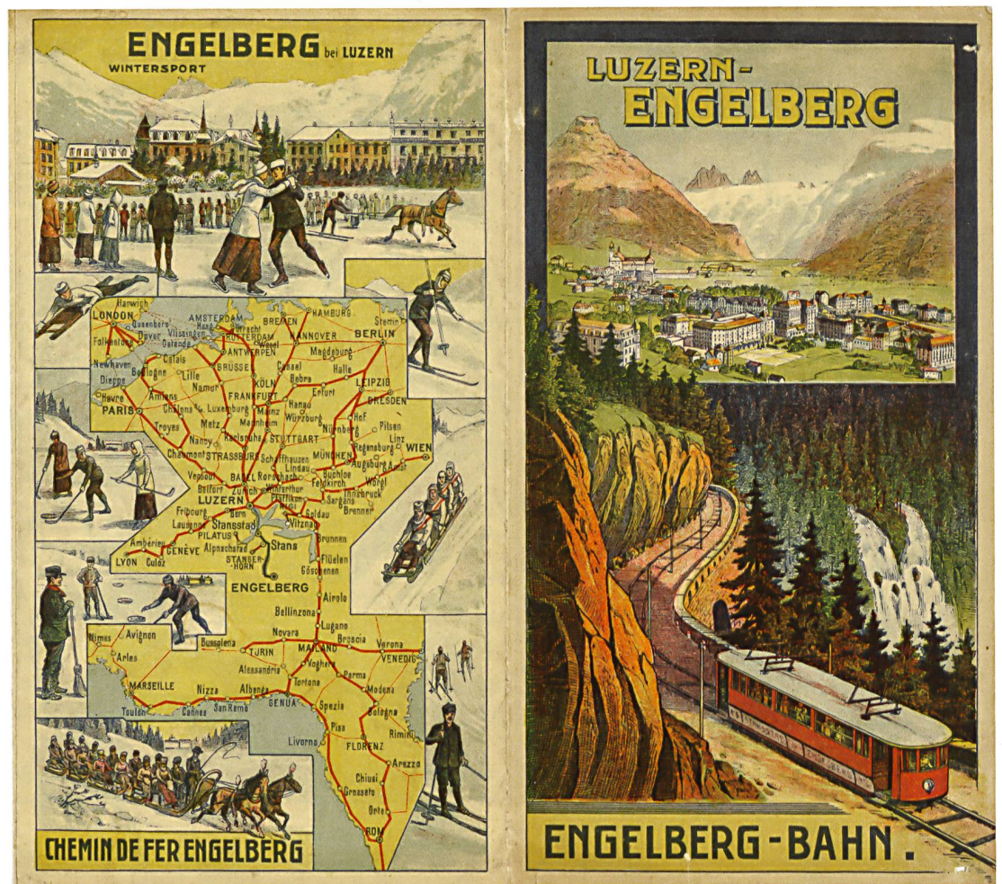
Abb. 37: Luzern-Engelberg / Engelberg-Bahn. Faltprospekt 11 x 20 cm, 1920. Der Triebwagen zeigt korrekt die Stromabnehmer für Drehstrom, man sieht aber keine Fahrleitungen. Eine Zahnstange gab es nur oberhalb von Grafenort.
