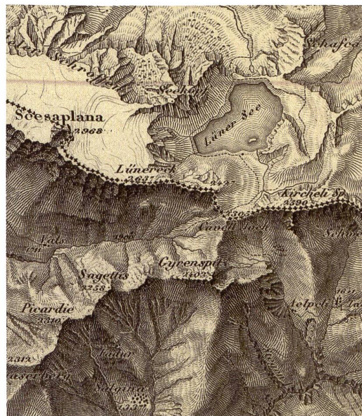
Abb. 60: Spezialkarte der Österreichisch-Ungarischen Monarchie, Blatt Zone 17, Colonne I, Bludenz und Vaduz 1:75 000. Ausschnitt in 1:100 000 verkleinert. Geländedarstellung in Böschungsschraffenmanier.
