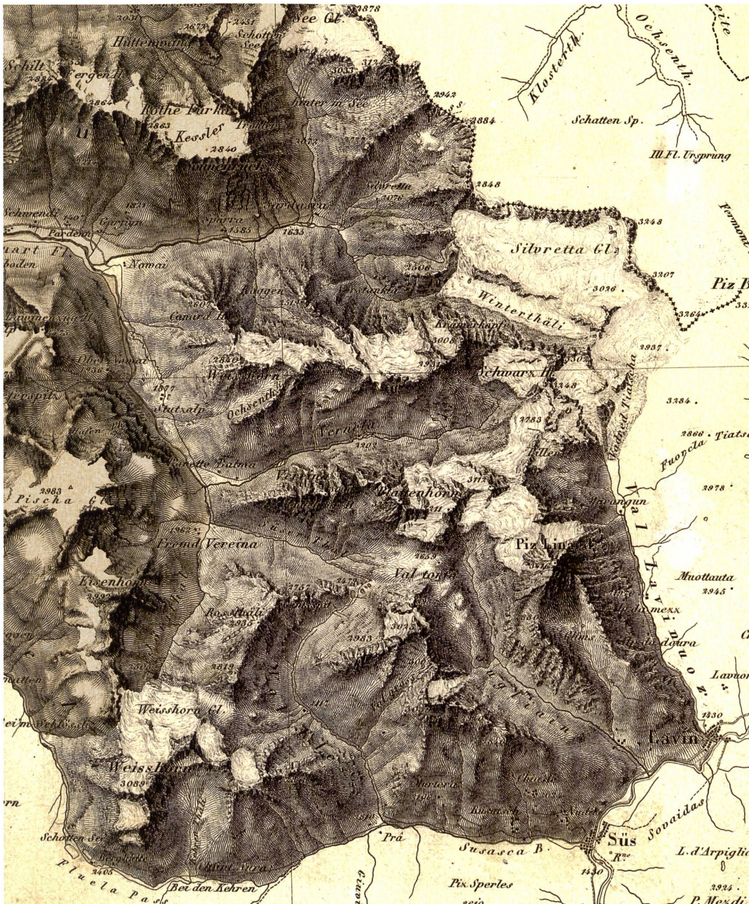
Abb. 50: Zustandsdruck für Blatt XV Davos Martinsbruck, mit gestochenerm «Trait» und Schraffen (linke Bildhälfte); mit Entwurf einer Schraffendarstellung, wahrscheinlich um 1852/53 gezeichnet von Johann Georg Steinmann mit Tusche und Bleistift (swisstopo Kartenarchiv, TKZ 100 15 7).
