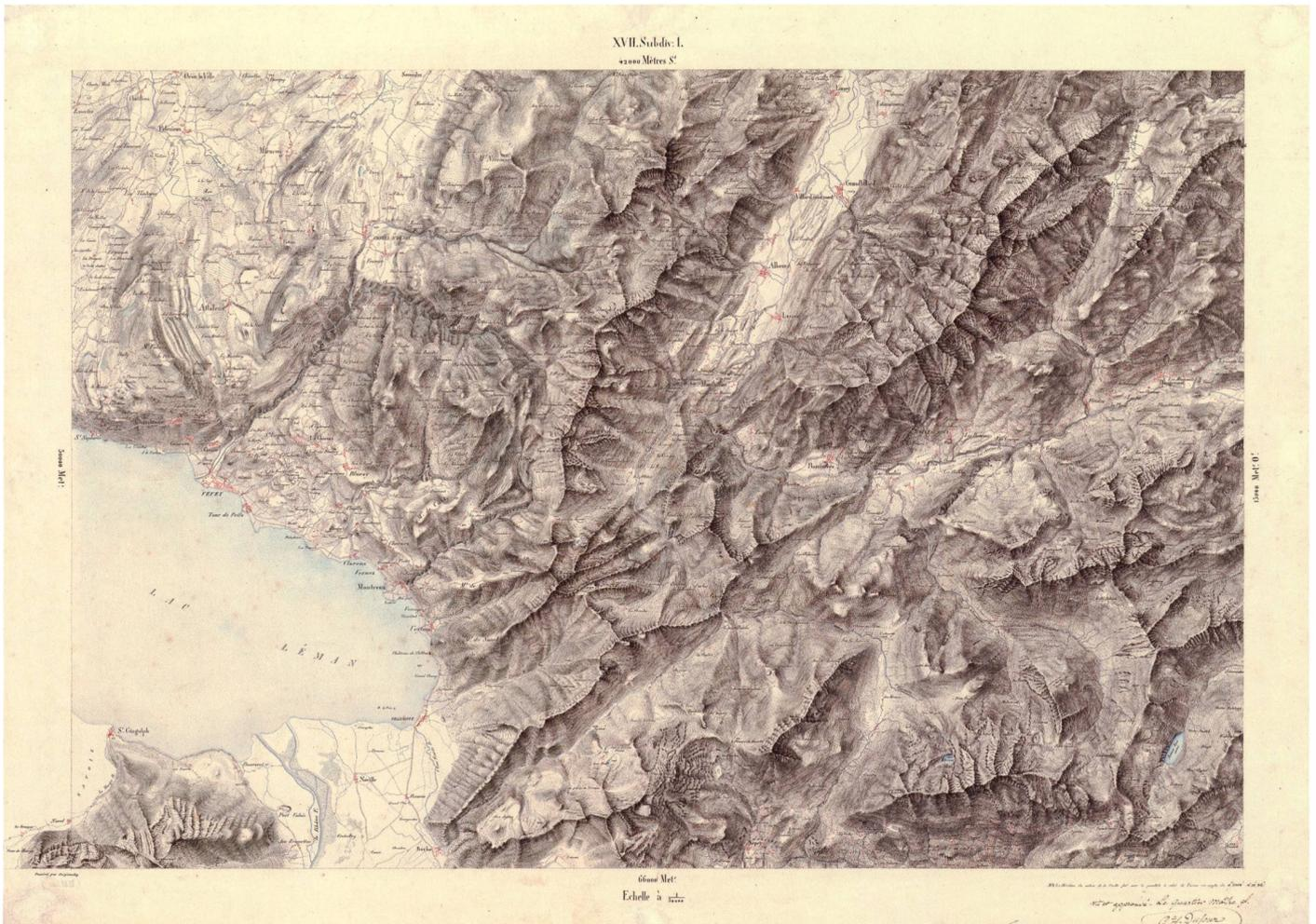
**Abb. 13:** Musterzeichnung für die Dufourkarte, Blatt XVII. Subdivision 1 im Massstab 1:50 000, um 1841. Farbige Tuschezeichnung von Stryieński, Format: 70 x 48 cm. Mit diesem Versuch wollte Dufour die Wirkung der angestrebten Felsdarstellung und der Schattenschraffen testen. Vielleicht diente diese Musterzeichnung auch als Vorlage für den Kupferstecher (swisstopo Kartensammlung, TKZ Studien 17 1).
