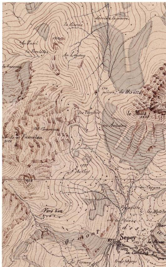
**Abb. 14:** Originalaufnahme («Minute») 1:50 000 von 1841 für die Dufourkarte, Blatt XVII. Farbige Tuschezeichnung mit Höhenkurven, Äquidistanz 30 m, Ausschnitt im Originalmassstab (swisstopo Kartensammlung, OA-380, 1841).
