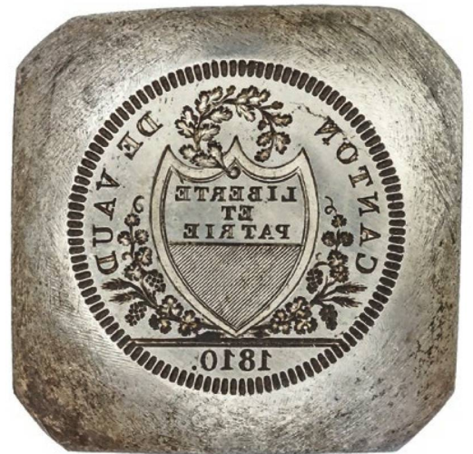
Avers- und Reversstempel für die Stosswerkprägung einer 20-Batzen-Münze. Kanton Waadt, Lausanne, 1810.
