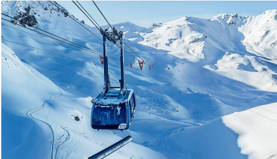
Die Urdenbahn in Arosa und Lenzerheide ist die schnellste Seilbahn der Schweiz. Die stützenlose Pendelbahn verbindet seit 2014 zwei Skigebiete, ohne neue Skipisten erschliessen zu müssen. Foto Ferienregion Lenzerheide
