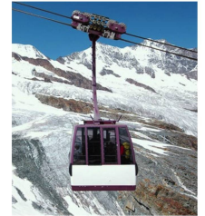
Auch diese Bahn steht für besondere Innovation: Die weltweit erste Luftseilbahn an drei Seilen schwebt seit 1991 in Saas Fee den Berg hoch. Foto Martin Arnold
