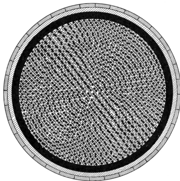
Fig. 26. Sternviererverseiltes Teilnehmerkabel zu 1204 \times 2 Adern (602 Vierer). Durchmesser über der Armatur 87,4 mm. Gewicht pro Meter 22 kg. Einführung dieses Kabeltyps in der Schweiz im Jahre 1924 Câble d'abonnés à 1204 \times 2 conducteurs toronnés en quarte-étoile (602 quarte). Diamètre sur l'armure 87,4 mm. Poids par mètre 22 kg. Ce type de câble est utilisé en Suisse depuis l'année 1924
