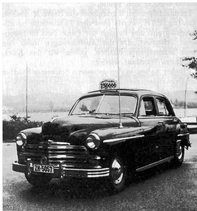
Fig. 1. Funk-Taxi der Fa. Welti-Furrer AG. Auf dem linken Kotflügel befindet sich eine ausziehbare Antenne, die zum Senden und Empfangen dient
