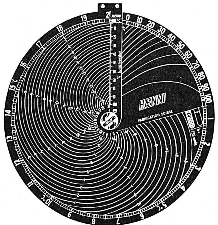
Fig. 11. Psychrometerrechenschieber Haenni nach Stucki und Uttinger
