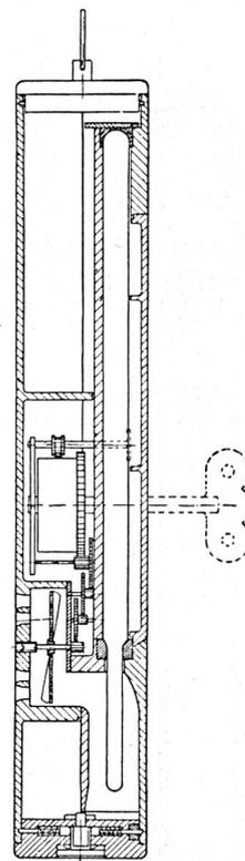
Fig. 9. Schnitt durch das Aspirations-Psychrometer *Haenni*
