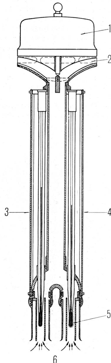
Fig. 7. Schnitt durch das Aspirations-Psychrometer nach Assmann
