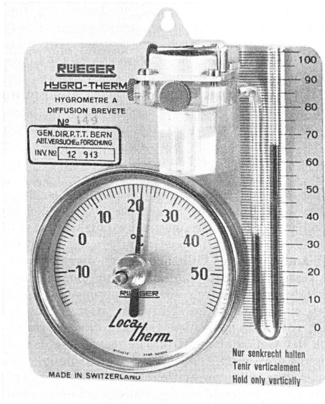
Fig. 12. Diffusionshygrometer nach Greinacher (Firma Rüegger, Lausanne)
