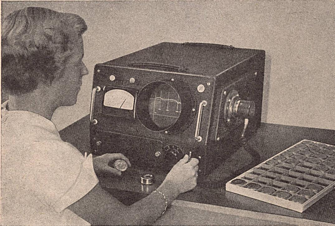
Jede Hörekapsel muss nach Fertigstellung auf Frequenzgang und Empfindlichkeit geprüft werden.
