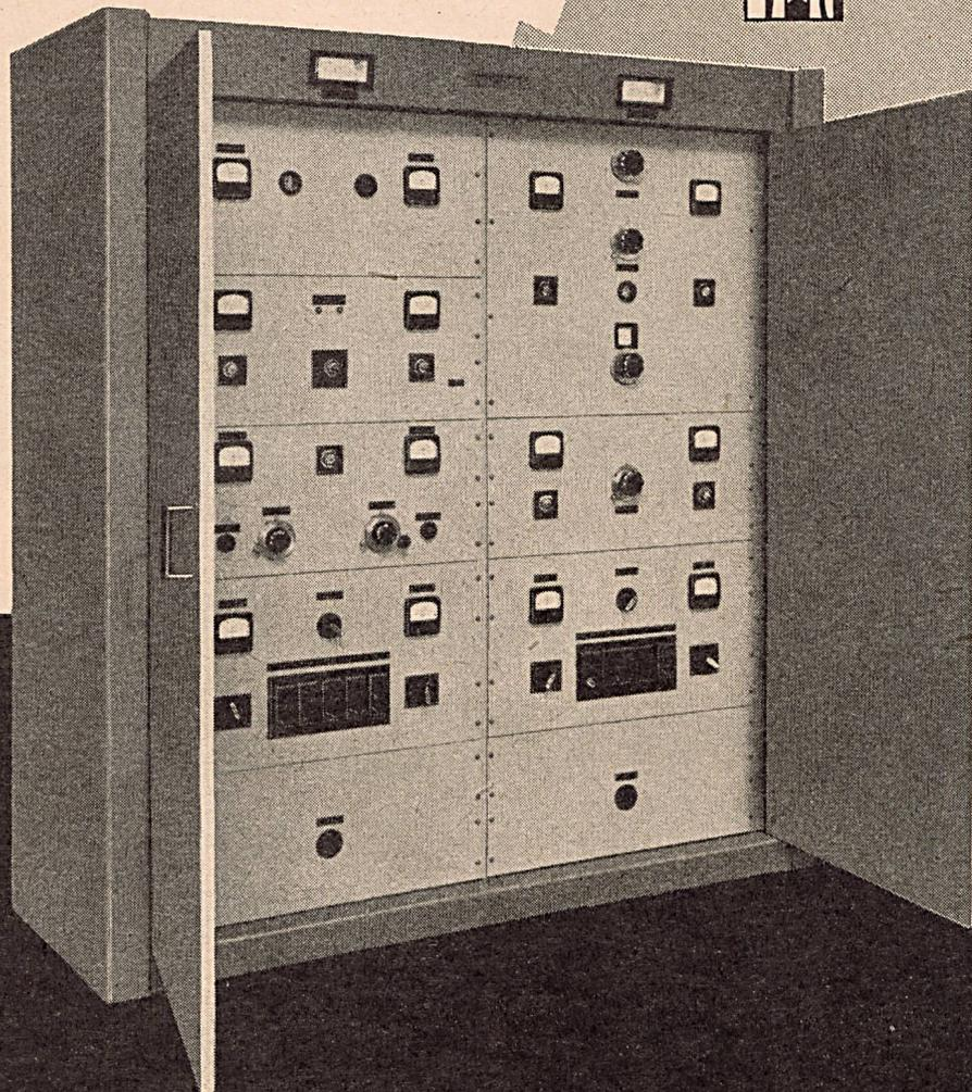
Zur Verbesserung der örtlichen Empfangsverhältnisse wurde in Basel ein neuer Stadtsender in Betrieb gesetzt. Er arbeitet mit der Frequenz von 1367 kHz und überträgt vollautomatisch das Programm von Beromünster.
