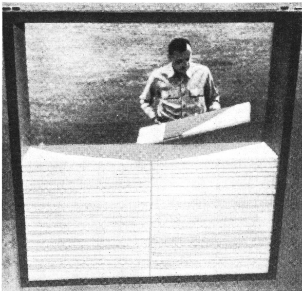
Fig. 11b. Ansicht der zum Teil montierten Linse
