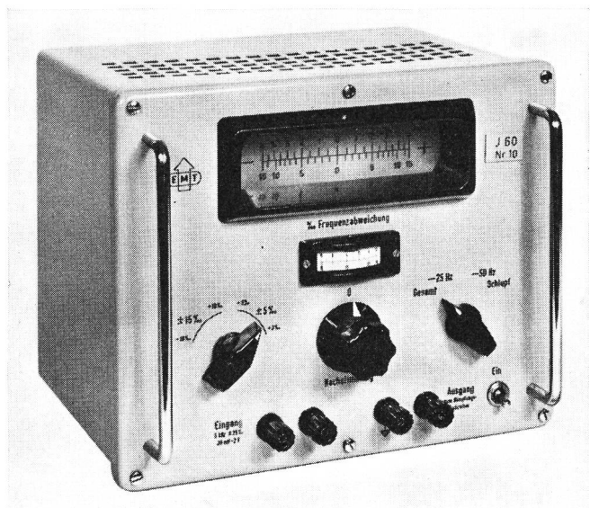
Fig. 1. Discriminateur «EMT» servant à mesurer les écarts instantanés d'un signal enregistré de 5000 Hz.
