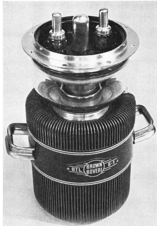
Fig. 11. Triode mit Luftkühlung (Brown-Boveri-Sendetriode BTL 6-1 mit thorierte Wolframkathode; Anodenverlustleistung 6 kW)
