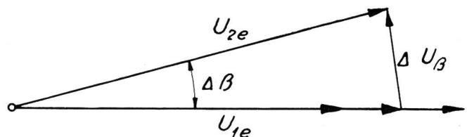
Fig. 24. Bestimmung der Phasenwinkeldifferenz zwischen zwei Paaren durch Messen der kleinsten Spannungsdifferenz  $\Delta U_{\beta} \cdot U_{1e}$  ist regulierbar
