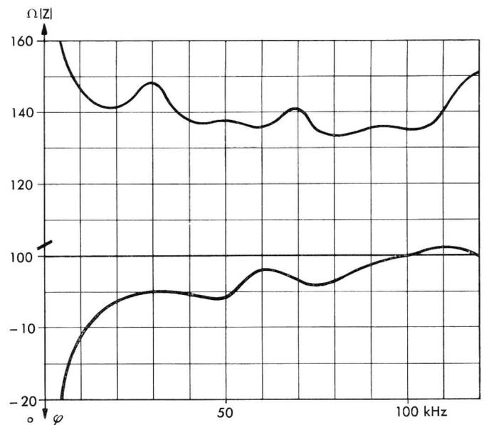
Fig. 33. Impedanzkurve eines älteren DM-Kabels
