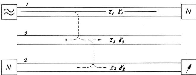
Fig. 20. Darstellung der Kopplung über dritte Stromkreise
