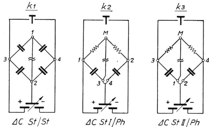
Fig. 5. Meßschaltungen zur Bestimmung der kapazitiven Kopplungen
