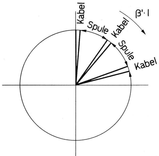
Fig. 7. Verteilung der Phasendrehung bei einem Pupinkabel
