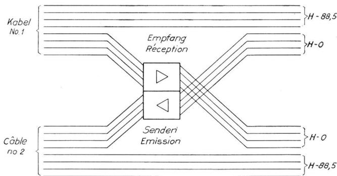
Fig. 13. Wechseln der Sprechrichtungen zum Ausgleich der Niveauunterschiede
