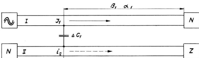
Fig. 21. Die Beeinflussung der Fernendkopplung durch Laufzeit- und Dämpfungsdifferenzen
