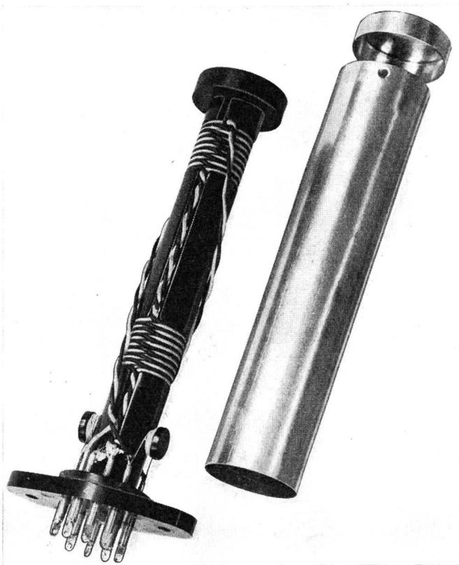
Fig. 26b. Ausführung des magnetischen Entkopplungsgliedes
