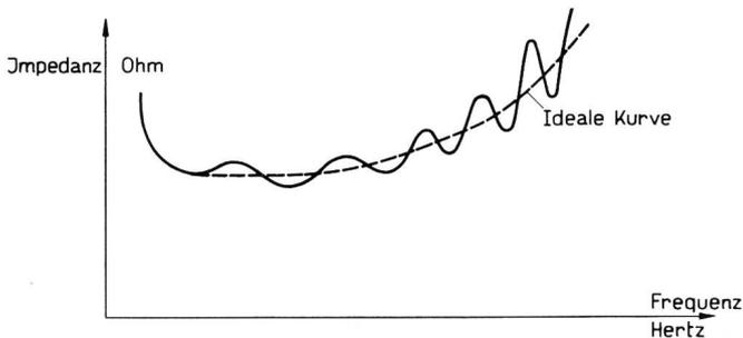
Fig. 11. Impedanzkurve eines pupinisierten Kabels mit Reflexionen
