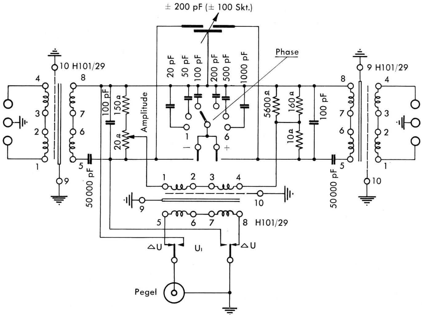
Fig. 23. Phasenmesser für Trägerkabel (Modell PTT-V 2)
