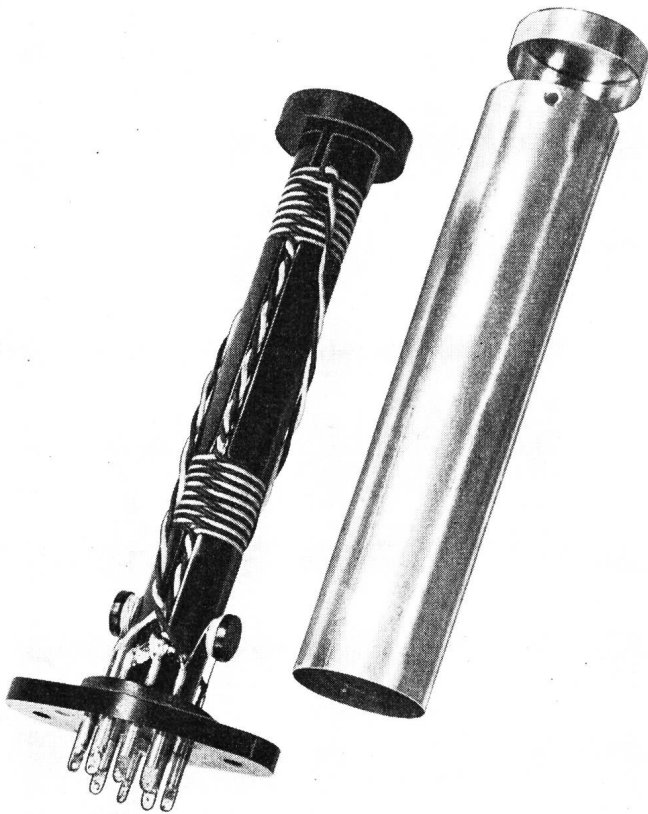
Fig. 26b. Exécution de l'élément de découplage magnétique
