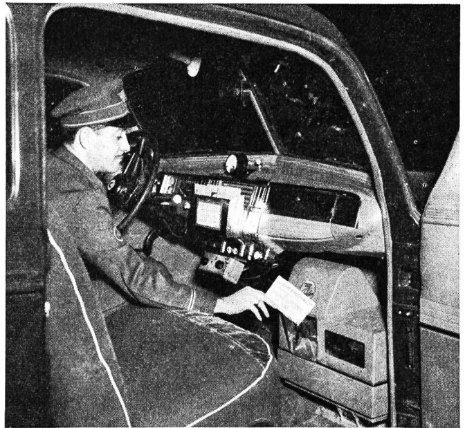
Fig. 7. Innenansicht eines Telecars (Zustellautomobils). Rechts, vor dem Chauffeur, der Faksimileapparat Intérieur d'un télécar (automobile de distribution). A droite, devant le conducteur, l'appareil fac-similé
