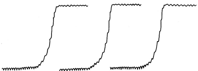
b) Blei-Polarogramme einer Kabelumhüllung mit 0,018 % Blei Polarogrammes d'une enveloppe de câble contenant 0,018 % de plomb
