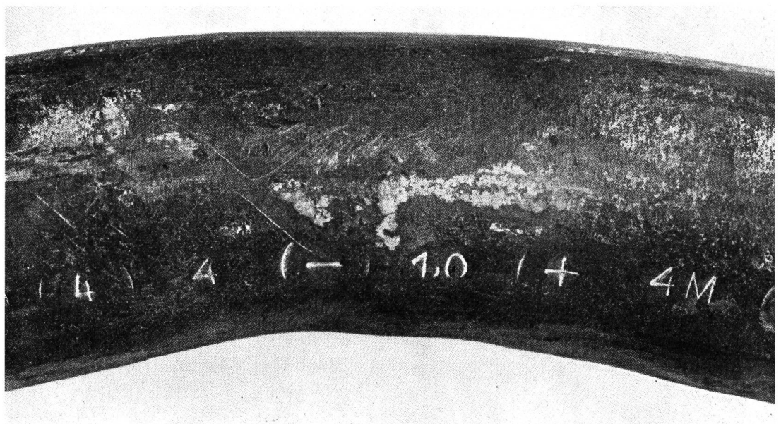
Fig. 11. Zustand des Bleimantels nach dem Dauerversuch am Muster Nr. 10a, Schrumpfschlauch Etat de la gaine de plomb après l'essai prolongé de l'échantillon N° 10a, enveloppe se resserrant sur la gaine
