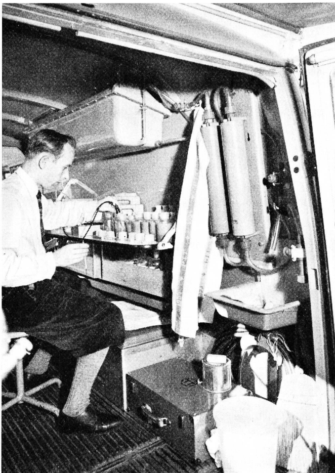
Fig. 3. In der Dachwölbung erkennt man den Wassertank aus Kunststoff, der über den 2-Säulen-Ionenaustauscher im Vordergrund gefüllt wird. Unter dem Wassereinsatzsalzer sieht man auch einen kleinen Brunnentrog aus Polyester. Die aufklappbare Tischplatte und das darunter befindliche Tablar dienen als Abstellflächen und als zusätzlicher Arbeitsplatz. Quer zum Profil des Bodenbelages aus Gummi ist noch eine der TT-Schienen zur Befestigung schwerer Geräte sichtbar
