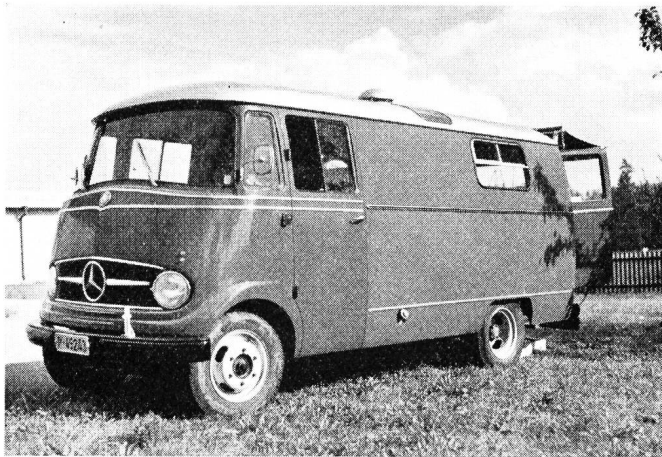
Fig. 1. Frontansicht des Feldlaborwagens Mercedes Typ L 319 D. Die Kastentüren hinten sind geöffnet und mit dem Vordach bespannt
