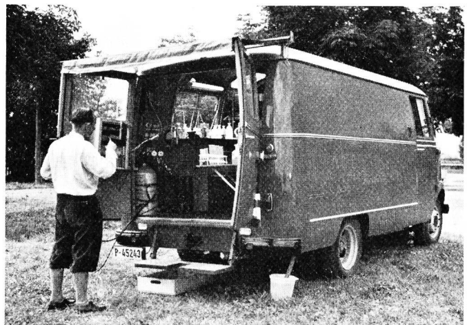
Fig. 4. Das über die offene Kastentüren gespannte Vordach dient nicht nur als Wetterschutz, sondern auch als Verstrebung. Beide Türflügel sind mit je einem Aufklapptischchen versehen. Das Tischchen links, das mit einem hitzebeständigen Material belegt ist, trägt einen Trockenschrank der mit Butagas oder, wie auf dem Bild, mit einem Azetylenbrenner betrieben wird. Auf dem Boden steht ein Kessel unter dem Ablaufrohr des Brunnentroges
