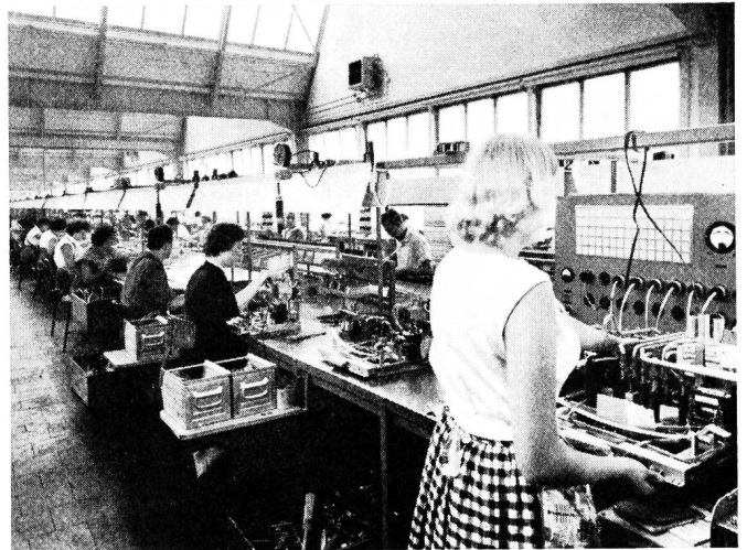
Fig. 3. In langen Reihen sitzen in dem auf das modernste eingerichtete Fernsehwerk Hunderte von Arbeiterinnen und Arbeiter an langen Werkbänken und fügen aus den Einzelteilen die Geräte zusammen. Die Fabrikation wird immer wieder durch vollautomatische Prüfgeräte überwacht, die – wie das im Vordergrund sichtbare – beim kleinsten Fehler eine Kontrolllampe auf dem Anzeigetableau aufleuchten lassen und so allfällige Mängel feststellen helfen
