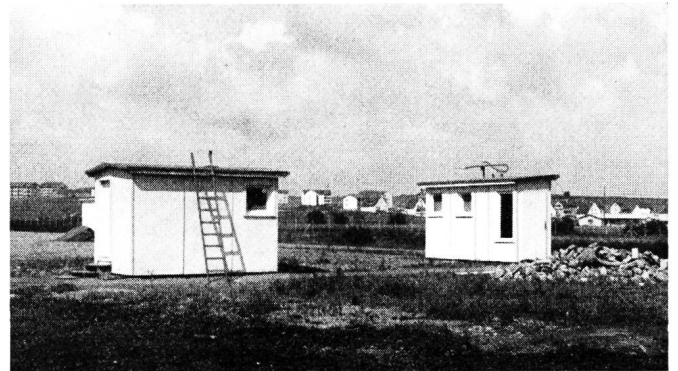
Fig. 5. Um den sehr strengen Anforderungen der Deutschen Post über die zulässigen Störstrahlungen von Rundfunk- und Fernsehgeräten genügen zu können, ist eine laufende Überwachung der Fabrikation auch in dieser Hinsicht nötig. Zu diesem Zwecke ist dieser Messplatz gebaut worden. Während im einen Häuschen der zu prüfende Empfänger auf einem drehbaren Tisch aufgestellt wird, befindet sich in dem zweiten, 10 m entfernten Bau der eigentliche Messplatz, zur Feststellung der ausgestrahlten Störfeldstärke in den verschiedenen Bereichen
