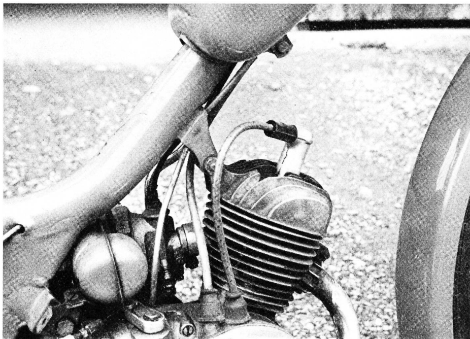
Fig. 7. Deparassitaggio d'un ciclo a motore ausiliario Si limita a un soppressore schermato innestato sulla candela
