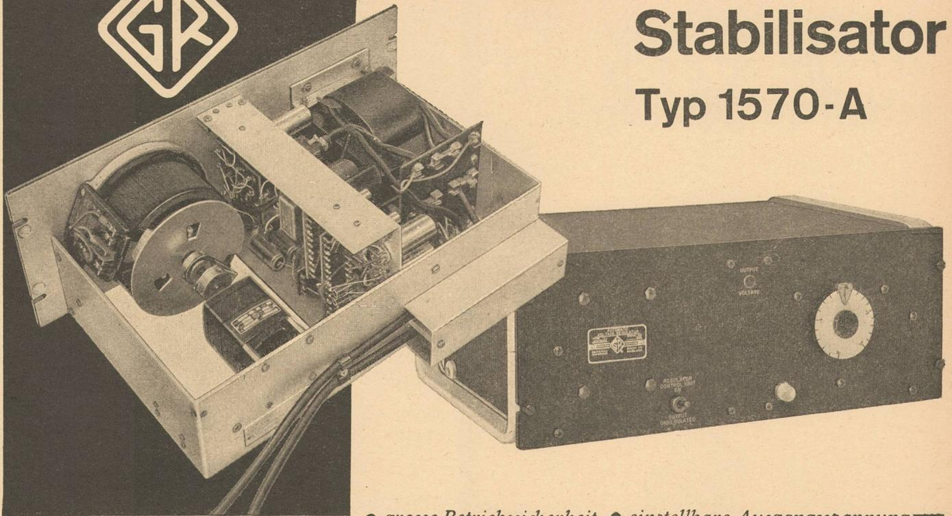
Dieser servo-mechanische Spannungs-Schnellregler besteht im wesentlichen aus einem motorangetriebenen, kugelgelagerten Variac-Regeltransformator kleinerer Leistung, einem Stufentransformator mehrfacher Leistung, einer Steuereinheit und dem Servomotor, der durch automatische Einstellung des Variacs die Ausgangsspannung konstant hält.
