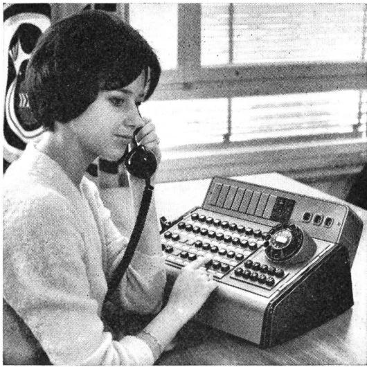
Fig. 2. Albis-Vermittlungsstation mit Leuchttasten und eingebautem Nummernanzeiger
