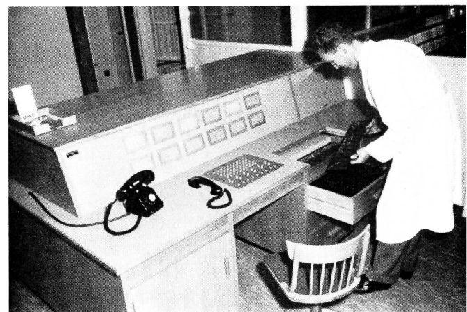
Fig. 4. Einlegen der Alarmmatrize in Abtastapparatur
