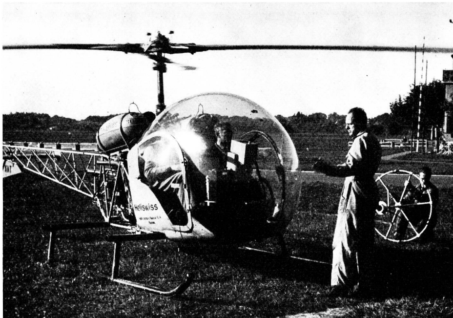
Fig. 7. Vorbereitung der Rundantenne vor dem Start zur Messung der Fernsehantenne La Dôle Préparation de l'antenne circulaire avant le départ pour la mesure de rayonnement de l'antenne de la Dôle
