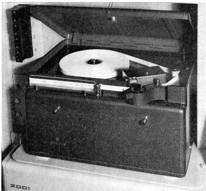
Fig. 5. Téléimprimeur Siemens-Hell Hell-Schreiber
