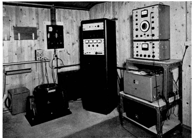
Fig. 2 Vibrationsanlage Derritron mit Steuerung Brüel & Kjaer. Von links nach rechts: Autotrafo für Netzsimulatorbetrieb, darüber Schiebewiderstand für die Feldkompensation (degaussing); Vibrator VP75 mit Kristall-Pick-ups, darüber Vorverstärker 2620; Verstärker 2,5 KWLF mit Ausgangstrafo dahinter; im Gestell: unten Felderreggerät, Schreiber Oscilloscript, Vibrationsmeter 2501, Steuergenerator 1040.
