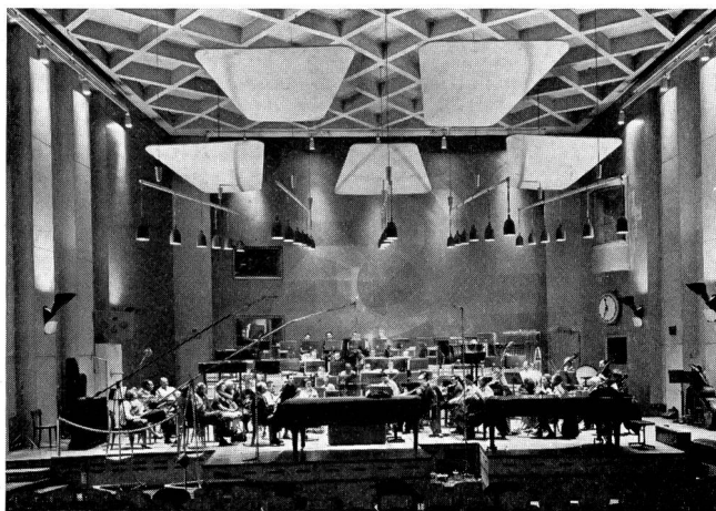
Fig. 5 Le grand studio de Zurich équipé de 5 réflecteurs ayant chacun une surface de 9 m 2
