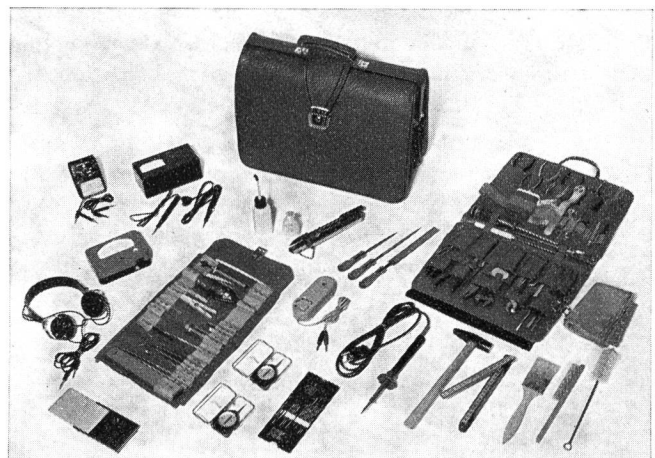
Fig. 7 Normales Sortiment von Werkzeugen und Instrumenten für Entstörer Assortiment normal d'outillage et d'instruments du réparateur de dérangements
