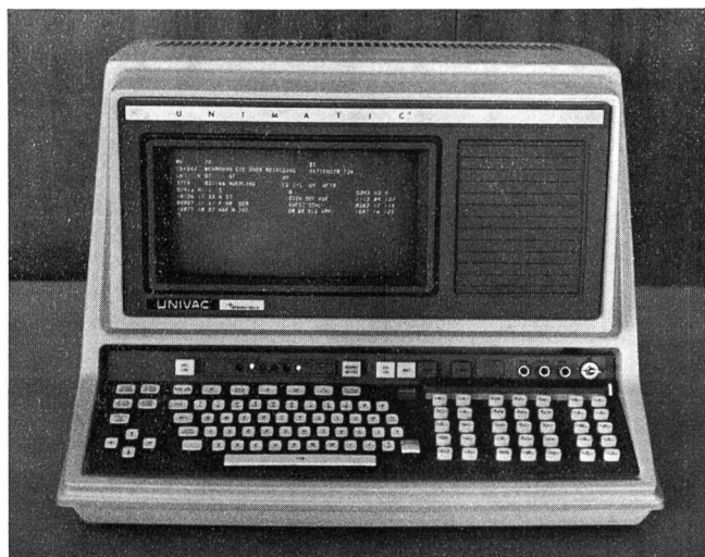
Fig. 2 Bildschirmgerät (display) für das neue Störungsdienstamt Zürich (oben) sowie die Einteilung des Bildschirms in 16 Zeilen zu 64 Zeichen (unten) Appareil à écran pour le nouveau centre du service des dérangements à Zurich (en haut); répartition de l'écran en 16 lignes de 64 signes chacune (en bas)
