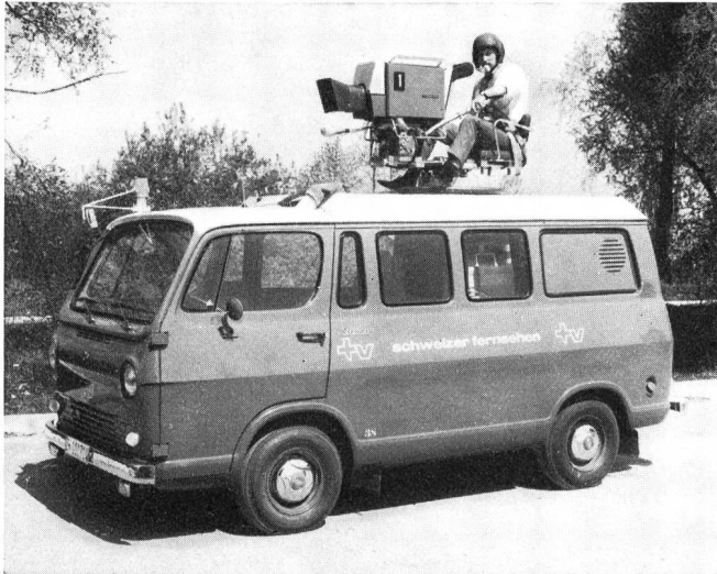
Fig. 2 Ein-Kamera-Reportagewagen für drahtlosen Einsatz (fahrbare Kamera) Une voiture légère de prise de vue ambulante avec liaison hertzienne
