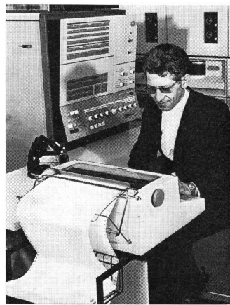
Fig. 5 Der Computer des Grossisten schreibt auf Grund der bei ihm beim Bestelleingang erstellten normalen Lochkarten den Lieferauftrag mit Adresse, voller Präparatsbezeichnung in einer auf die Lagerung abgestimmten Reihenfolge aus
