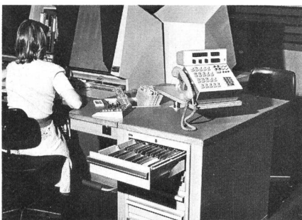
Fig. 8 Schwenkbare Kontrollstation mit Bedienungsplatz rechts und Mikrofilmleseplatz links
