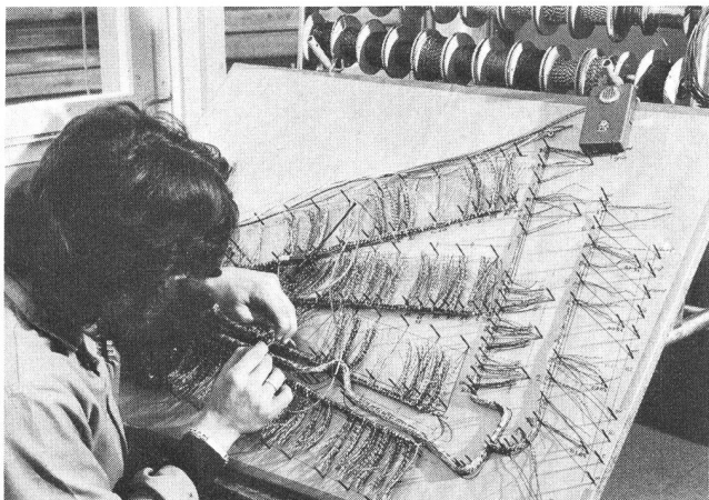
Fig. 5 Grundausbildung 2: Die Kabelform wird ausgeprüft – Formation de base 2: la forme de fils est testée
