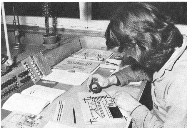
Fig. 2 Herstellung eines Lay-out im Massstab 2:1 für die Produktion von gedruckten Schaltungen – Réalisation d'un «lay-out» à l'échelle 2:1 pour la production de circuits imprimés
