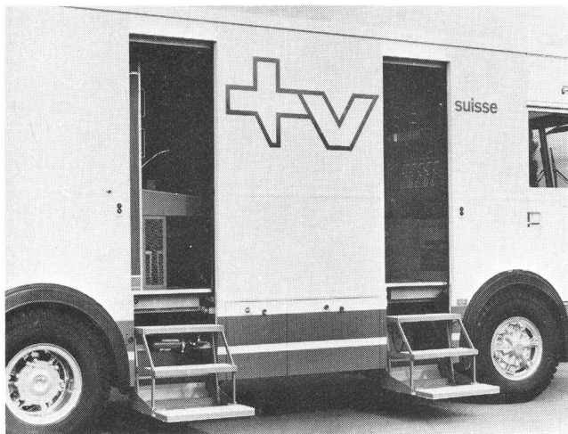
Fig. 2 Seitenansicht rechts. Schiebetüren geöffnet und Treppen ausgeklappt. Links Eingang zu Bildregie und Bildtechnik, rechts Tonregie – Vue du côté droit, portes coulissantes ouvertes et escaliers d'accès déployés. A gauche, entrée des locaux de la régie et de la technique vidéo, à droite, régie son
