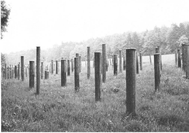
Fig. 6 Jardin de poteaux pour les essais de durée près de Lucerne – Terre- no sperimentale per ricerche a lungo termine, nei pressi di Lucerna
