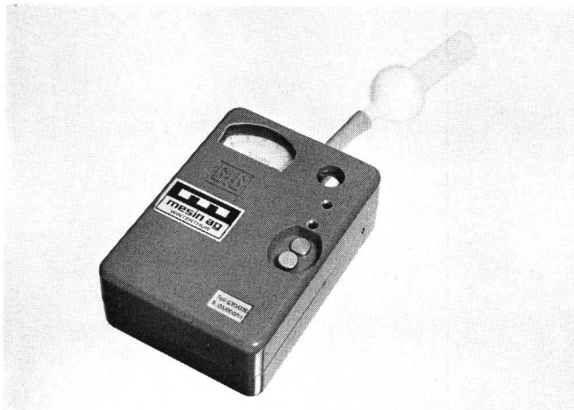
Fig. 12 Überprüfung der Gerätefunktionsbereitschaft. Das Kunststoffröhrchen mit dem Wattebausch ist mit einem Gummischlauch-Zwischenstück an den Ansaugstutzen des Gasotrans angeschlossen – Contrôle du fonctionnement de l'appareil. Le tube de test renflé est relié par un tuyau de caoutchouc au raccord du Gasotrans
