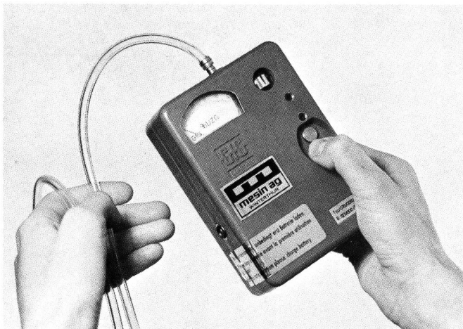
Fig. 4 Das Explosimeter Gasotrans im Einsatz. Normalerweise ist das Gerät hierzu in der Ledertasche zu lassen. Es ist darauf zu achten, dass die Luft-Auslassbohrung auf der Rückseite des Gehäuses beim Halten des Gerätes frei bleibt – Explosimeter Gasotrans prêt à l'emploi. D'ordinaire, il faut laisser l'appareil dans sa sacoche de cuir. Il faut veiller à ne pas obstruer avec la main l'orifice d'évacuation d'air situé sur la face arrière
