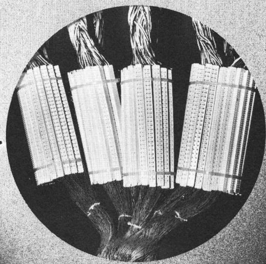
Das lötfreie, mechanische Modul-Spleiss-System (MS<sup>2</sup>) erleichtert die Arbeit des Fernmelde-Spezialisten wesentlich. In einem Arbeitsgang werden 28 Aderpaare abisoliert, verbunden und geschnitten. Ein Identifizieren, Prüfen und Umspleissen ist jederzeit problemlos möglich.
