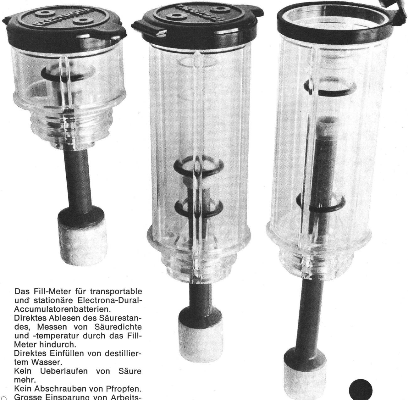
Das Fill-Meter für transportable und stationäre Electrona-Dural-Accumulatoren-Batterien. Direktes Ablesen des Säurestandes, Messen von Säuredichte und -temperatur durch das Fill-Meter hindurch. Direktes Einfüllen von destilliertem Wasser. Kein Ueberlaufen von Säure mehr. Kein Abschrauben von Pfropfen. Grosse Einsparung von Arbeitszeit und Unterhaltskosten.
