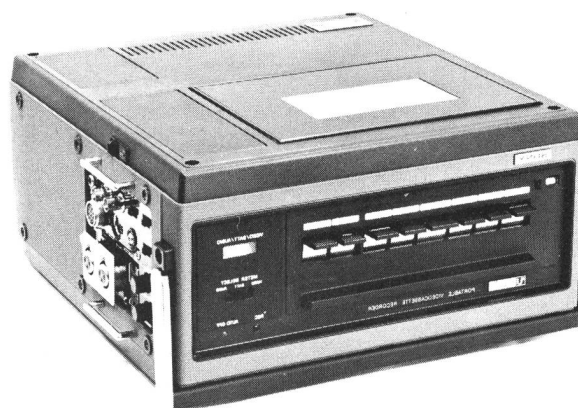
Fig. 10 Enregistreur U-matic. Modèle portable pour l'enregistrement
