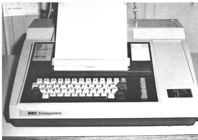
Fig. 8 Bedienplatz zur Videotex-Anlage – Console de service de l'installation Videotex
