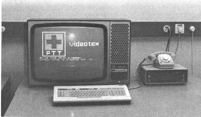
Fig. 3 Videotex-Anlage bestehend aus gewöhnlichem Fernsehempfänger und Telefonapparat sowie einem Modem und einem Fernsteuerungsgerät – Installation Videotex se composant d'un récepteur de télévision et d'un appareil de téléphone ordinaires, ainsi que d'un modem et d'un dispositif de télécommande
