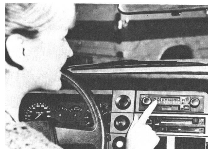
Fig. 18 Das Mikrocomputer-Autoradio von Philips, in dessen Gedächtnis 60 FM- und AM-Sender gespeichert werden können, und zwar als «Programmketten» von jeweils 10 Stationen. Während der Fahrt übernimmt der Computer die Wahl des jeweils bestempfangbaren Senders des gewählten Programms automatisch (Foto Philips)
