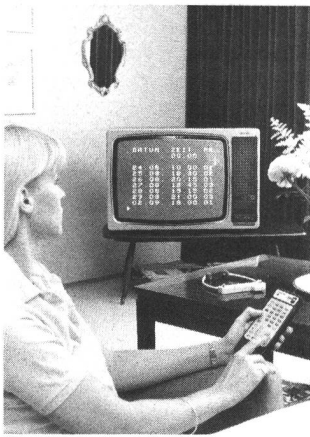
Fig. 4 Auf Tastendruck zeigt dieser TV-Empfänger die im Mikrocomputer gespeicherten Programmdateien auf dem Bildschirm an
