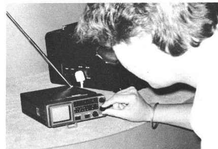
Fig. 22 Mini-Schwarzweiss-Fernsehgerät mit herkömmlicher Elektronenstrahlbildröhre
