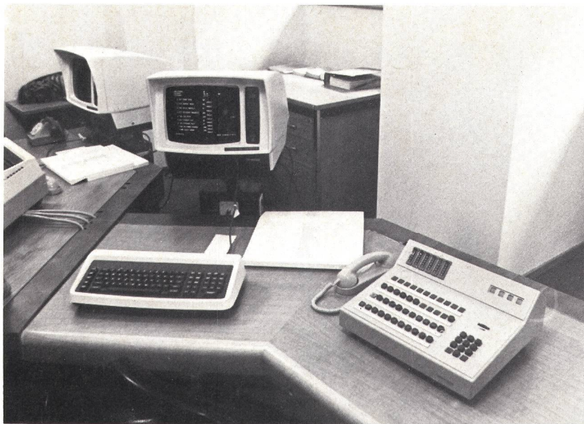
Fig. 3 Der modern eingerichtete Vermittlerplatz mit Bildschirmgerät und Zugriffsmöglichkeit zum Computer
