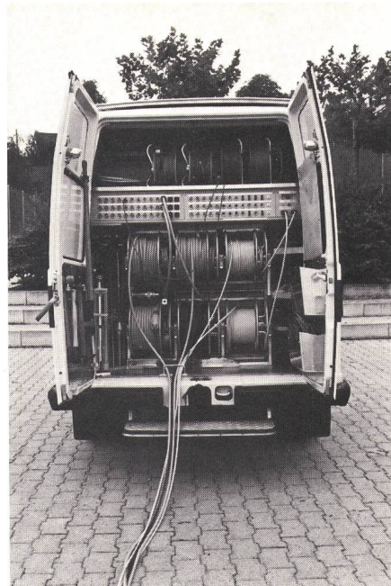
Fig. 5 Fahrzeugrückteil mit Kabelrollen und Anschlussfeldern — Partie arrière du véhicule avec compartiment des câbles et tableau de raccordement
