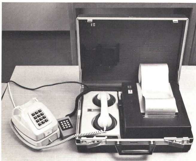
Fig. 25 Pikettstelle. Koffer mit Akustikkoppler, Drucker und Mikroterminal – Service de piquet. Attaché-case avec coupleur acoustique, imprimante et microterminal
